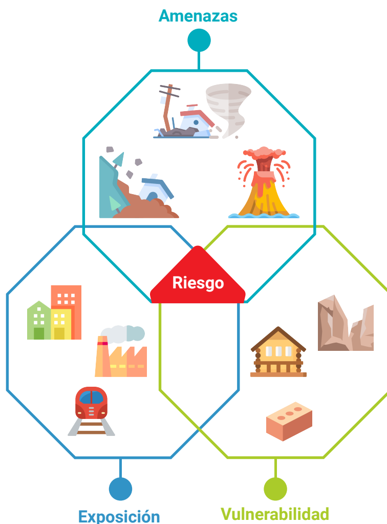
Figura 6: El riesgo definido como la interacción ente la exposición, vulnerabilidad y las amenazas.
